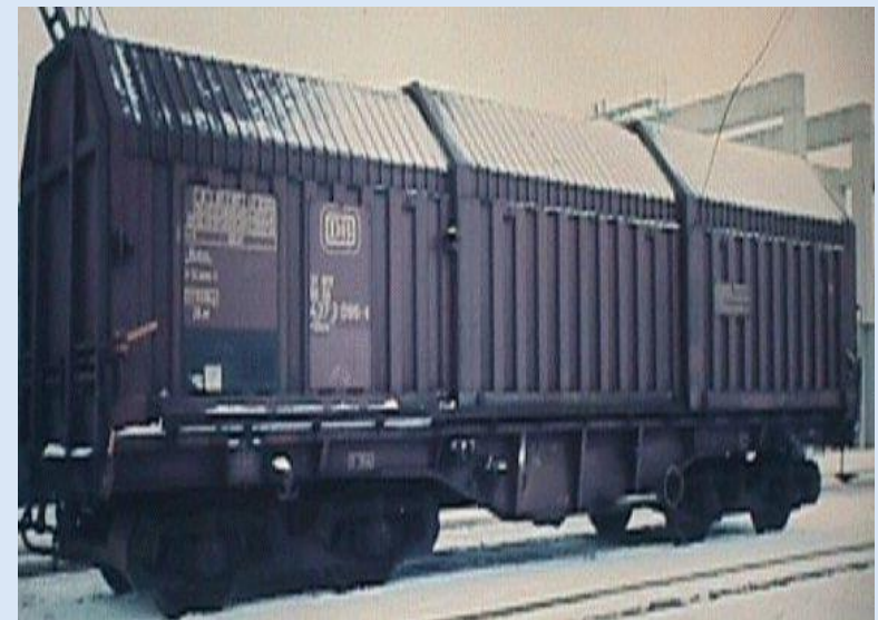
Σιδηροδρομική μεταφορά μεταλλικών πηνίων σε βαγόνι με τηλεσκοπική οροφή
