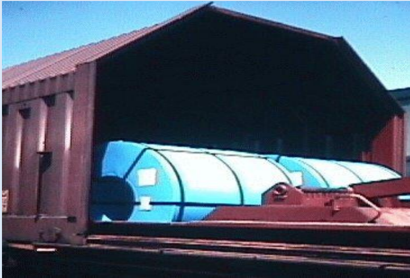
Σιδηροδρομική μεταφορά μεταλλικών πηνίων σε βαγόνι με τηλεσκοπική οροφή
